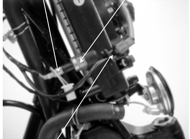
Fan Motor Wire Coupler
